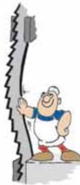
Utilice siempre la tensión correcta en la Hoja de Sierra Cinta. Manténgala en posición mientras realiza el corte. Un exceso de tensión puede ocasionar rotura en la hoja de sierra.
