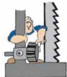
Ajuste el soporte posterior de tal modo sirva de apoyo a la Hoja de Sierra Cinta únicamente durante su funcionamiento.
